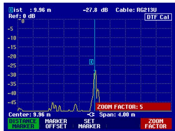
检查被测量电缆的反射衰耗：
