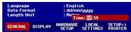
在最后的时间输入后，FSH3 将自动检查所输入的时间是否有效，如果无效，仪器将提示输入有效时间。
