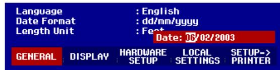
在最后的日期输入后，FSH3 将自动检查所输入的日期是否是有效的，如果无效，仪器将提示输入有效日期。
