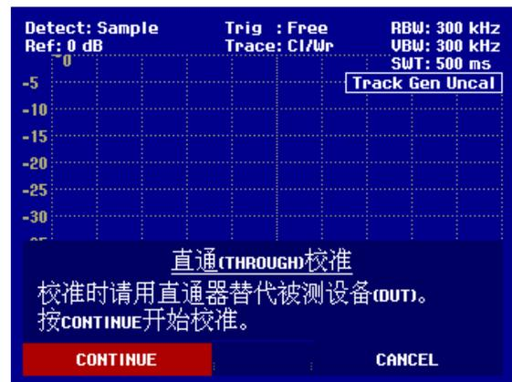
校准完毕后， FSH3 频谱仪屏幕显示 3 秒钟 "传输校准成功"
