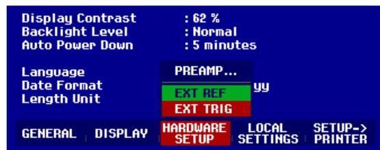
EXT TRIG 的设置仅用于输入的配置。外部触发的应用应在 Sweep 菜单中设置 (SWEEP 键, TRIGGER 键)。
