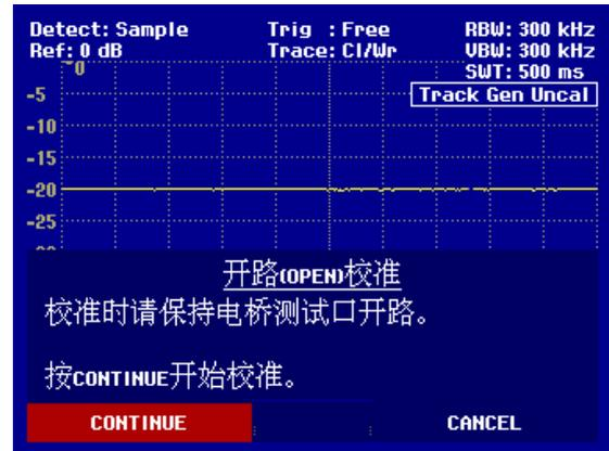
在 OPEN 校准完毕后，FSH3 频谱仪提示用户进行 SHORT 校准的工作。
