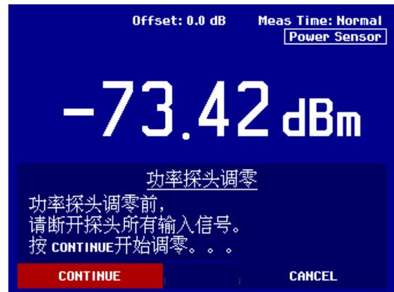
当调零程序完毕, FSH3 频谱仪再次显示 给 用信息 "功率探头调零成功", 然后, 调回到菜单项来使用功率探头。
